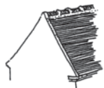
Les pignons sont francs, sans débord de toiture.
